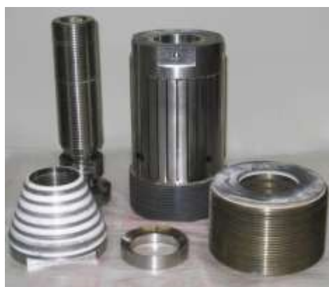
Рис. 22. Опытный макет ГМО после испытаний
