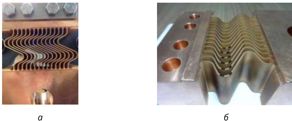
Рис. 24. ЭС после 1-го (а) и 2-го (б) этапов механических циклических испытаний
