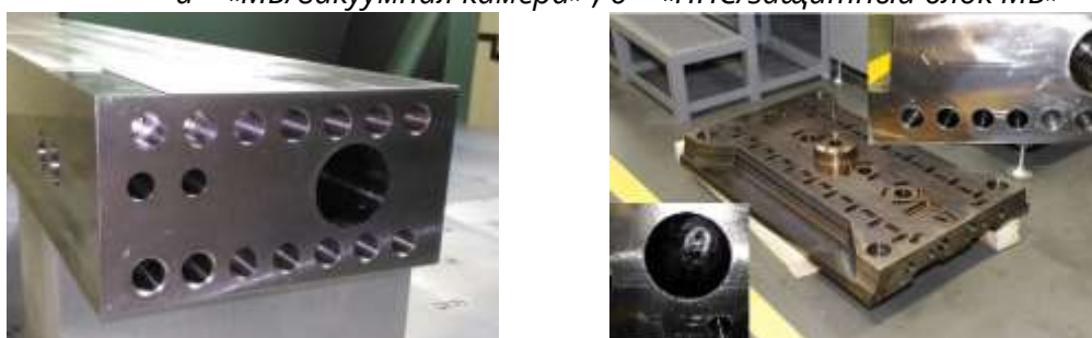
а б Рис. 18. Макеты изделий ИТЭР с выполненными глубокими отверстиями: а – технологический; б – НКПС
