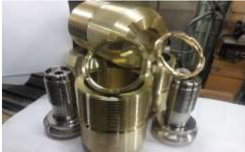
Рис. 19. Макеты компонентов ППС: а – корпуса пальцев; б – НКПС; в – элементы системы крепления; г – электроизоляционные шайбы
